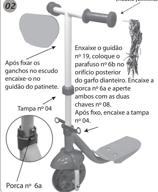
Encaixe o guidão nº 19, coloque o parafuso nº 6b no orifício posterior do garfo dianteiro. Encaixe a porca nº 6a e aperte ambos com as duas chaves nº 08. Após fixo, encaixe a tampa nº 04.
